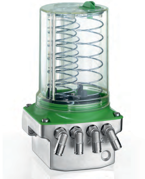
FlexxPump 400 DLS: impuls-gesteuerter Nachschmiergeber für bis zu 16 Schmierstellen; 400 cm 3 Kartusche; 24 VDC (abgebildet: Typ 404 DLS)
