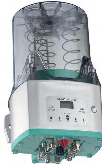
FlexxPump 1500: automatischer Nachschmiergeber; für 1500 cm 3 Fett-Faltenbalg; 24 VDC (abgebildet: Typ 1510)
