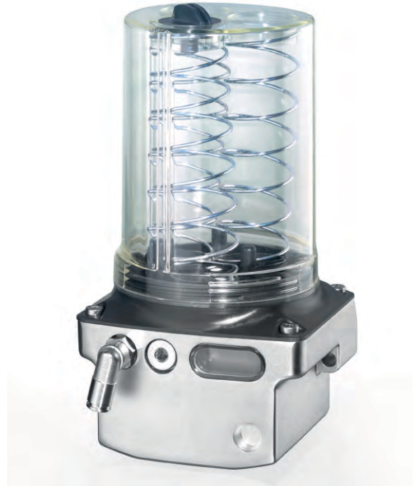
FlexxPump 401 B: autarker, zeitgesteuerter Nachschmiergeber Fett; für 400 cm 3 Kartusche; Gehäuse-Abdeckung (grau); ohne M12x1-Stecker; für 3V Batteriebetrieb; (abgebildet: 135-140-000)
