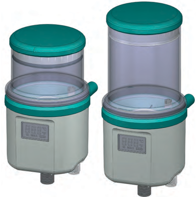
FlexxPump 125: 24V DC-betriebener Nachschmiergeber für Fett; 125 bzw. 250 cm 3 Kartusche aufgesetzt; (abgebildet: 135-125-210 mit Kartusche 125 bzw. 250)
