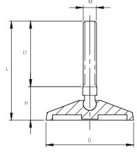
Material: GLASS FIBER REINFORCED POLYAMID BASE
